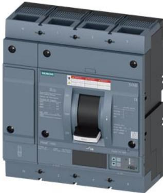
interruttore automatico 3VA6 UL frame 800 classe del potere di interruzione M 35 kA con 480 V a 4 poli, protezione impianto ETU550, LSI, In=600 A protezione da sovraccarico, 100 % nominale Ir=240 A ... 600 A protezione da cortocircuito I<sub>sd</sub>=0,6 ... 12x I<sub>n</sub>, I<sub>i</sub>=1,5..12x I<sub>n</sub> protezione del conduttore di neutro regolabile (OFF, fino a 130 %) attacchi piatti a vite
