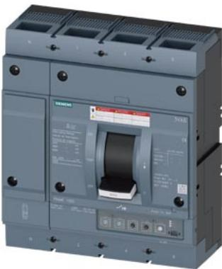
interruttore automatico 3VA6 UL Frame 800 classe del potere di interruzione M 35 kA con 480 V a 4 poli, protezione impianto ETU350, LSI, In=600 A, protezione da sovraccarico Ir=240 A ... 600 A protezione da cortocircuito lsd=1,5 ... 12 x Ir, li=12 x In protezione del conduttore di neutro impostabile (OFF, 50 %, 100 %) attacchi piatti a vite
