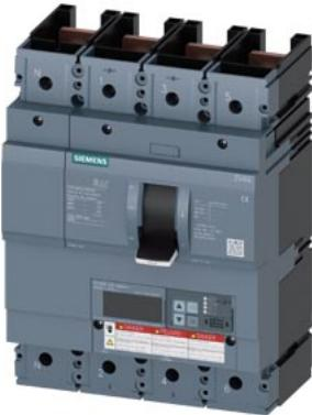
interruttore automatico 3VA6 UL Frame 600 classe del potere di interruzione L 150 kA con 480V a 4 poli, protezione impianto ETU856, LSI, In=600 A, protezione da sovraccarico Ir=240A ... 600A protezione da cortocircuito Isd=0,6 ... 9x In, Ii=1,5 ... 9x In protezione del conduttore di neutro impostabile (OFF, fino a 100%) allarme di guasto verso terra segnalazione tramite EFB300 o COM senza collegamento
