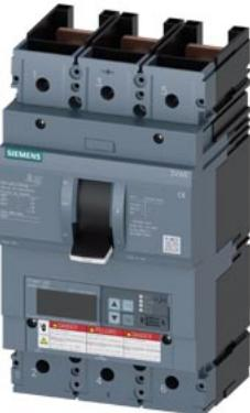
interruttore automatico 3VA6 UL Frame 600 classe del potere di interruzione L 150 kA con 480V a 3 poli, protezione impianto ETU860, LSIG, In=600 A, protezione da sovraccarico Ir=240A ... 600A protezione da cortocircuito Isd=0,6 ... 9x In, Ii=1,5 ... 9x In protezione del conduttore di neutro opzionale con trasformatore di corrente, fino a 160% protezione da guasto verso terra Ig=0,2...1 x In, tg=0,05...0,8s senza collegamento
