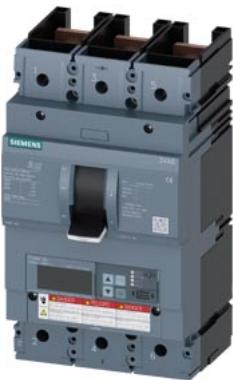
interruttore automatico 3VA6 UL Frame 600 classe del potere di interruzione L 150 kA con 480V a 3 poli, protezione impianto ETU830, LIG, In=600 A, protezione da sovraccarico Ir=240A ... 600A protezione da cortocircuito Ii=1,5 ... 9 x In protezione da guasto verso terra Ig=0,2...1 x In, tg=0,05...0,8s senza collegamento
