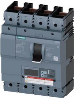
interruttore automatico 3VA6 UL Frame 600 classe del potere di interruzione L 150 kA con 480V a 4 poli, protezione impianto ETU556, LSI,  $In=600$  A, protezione da sovraccarico  $Ir=240$  A ... 600A protezione da cortocircuito  $Isd=0,6$  ... 9x  $In$ ,  $li=1,5$  ... 9x  $In$  protezione del conduttore di neutro impostabile (OFF, fino a 100%) allarme di guasto verso terra segnalazione tramite EFB300 o COM senza collegamento
