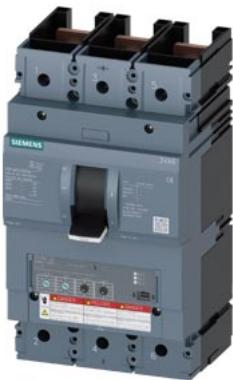
interruttore automatico 3VA6 UL Frame 600 classe del potere di interruzione L 150 kA con 480V a 3 poli, protezione impianto ETU350, LSI, In=600 A, protezione da sovraccarico Ir=240A ... 600A protezione da cortocircuito Isd=1,5...9 x Ir, Ii=9 x In senza collegamento
