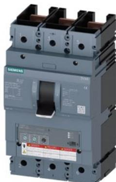
interruttore automatico 3VA6 UL Frame 600 classe del potere di interruzione C 100 kA con 480V a 3 poli, protezione impianto ETU320, LI, In=600 A, protezione da sovraccarico Ir=240A ... 600A protezione da cortocircuito li=1,5 ... 9 x In senza collegamento
