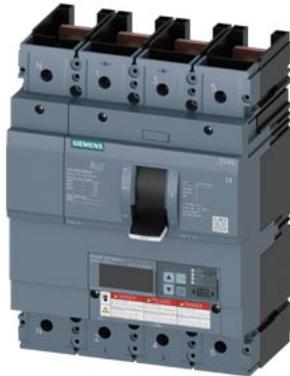
interruttore automatico 3VA6 UL Frame 600 classe del potere di interruzione H 65 kA con 480V a 4 poli, protezione impianto ETU856, LSI, In=600 A, protezione da sovraccarico Ir=240A ... 600A protezione da cortocircuito I<sub>sd</sub>=0,6 ... 9x I<sub>n</sub>, I<sub>i</sub>=1,5 ... 9x I<sub>n</sub> protezione del conduttore di neutro impostabile (OFF, fino a 100%) allarme di guasto verso terra segnalazione tramite EFB300 o COM senza collegamento
