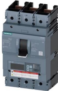
interruttore automatico 3VA6 UL Frame 600 classe del potere di interruzione H 65 kA con 480V a 3 poli, protezione impianto ETU860, LSIG,  $I_n=600$  A, protezione da sovraccarico  $I_r=240A \dots 600A$  protezione da cortocircuito  $I_{sd}=0,6 \dots 9 \times I_n$ ,  $I_i=1,5 \dots 9 \times I_n$  protezione del conduttore di neutro opzionale con trasformatore di corrente, fino a 160% protezione da guasto verso terra  $I_g=0,2 \dots 1 \times I_n$ ,  $t_g=0,05 \dots 0,8s$  senza collegamento
