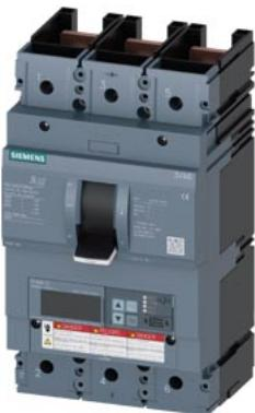
interruttore automatico 3VA6 UL Frame 600 classe del potere di interruzione H 65 kA con 480V a 3 poli, protezione impianto ETU820, LI, In=600 A, protezione da sovraccarico Ir=240A ... 600A protezione da cortocircuito I<sub>c</sub>=1,5 ... 9 x I<sub>n</sub> senza collegamento
