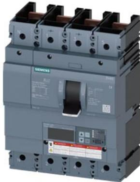
interruttore automatico 3VA6 UL Frame 600 classe del potere di interruzione H 65 kA con 480V a 4 poli, protezione impianto ETU560, LSIG,  $I_n=600$  A, protezione da sovraccarico  $I_r=240A \dots 600A$  protezione da cortocircuito  $I_{sd}=0,6 \dots 9 \times I_n$ ,  $I_i=1,5 \dots 9 \times I_n$  protezione del conduttore di neutro impostabile (OFF, fino a 100%) protezione da guasto verso terra  $I_g=0,2 \dots 1 \times I_n=$   $t_g=0,05-0,8s$  senza collegamento
