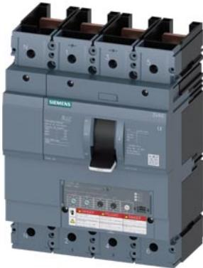
interruttore automatico 3VA6 UL Frame 600 classe del potere di interruzione H 65 kA con 480V a 4 poli, protezione impianto ETU330, LIG, In=600 A, protezione da sovraccarico Ir=240A ... 600A protezione da cortocircuito Ii=1,5 ... 9 x In protezione del conduttore di neutro impostabile (OFF, 50%, 100%) protezione da guasto verso terra Ig=0,2...1 x In= tg=0,1/0,3s senza collegamento
