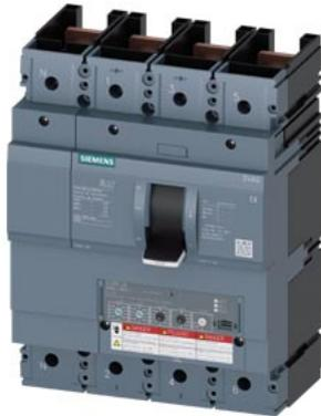
interruttore automatico 3VA6 UL Frame 600 classe del potere di interruzione M 35 kA con 480V a 4 poli, protezione impianto ETU350, LSI,  $I_n=600$  A, protezione da sovraccarico  $I_r=240A \dots 600A$  protezione da cortocircuito  $I_{sd}=1,5\dots 9 \times I_r$ ,  $I_i=9 \times I_n$  protezione del conduttore di neutro impostabile (OFF, 50%, 100%) senza collegamento
