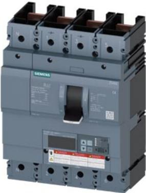
interruttore automatico 3VA6 UL Frame 600 classe del potere di interruzione E 200 kA con 480 V a 4 poli, protezione impianto ETU856, LSI, In=600 A, protezione da sovraccarico Ir=240 A ... 600 A protezione da cortocircuito lsd=0,6 ... 9x In, li=1,5 ... 9x In protezione del conduttore di neutro impostabile (OFF, fino a 100%) allarme di guasto verso terra segnalazione tramite EFB300 o COM senza collegamento
