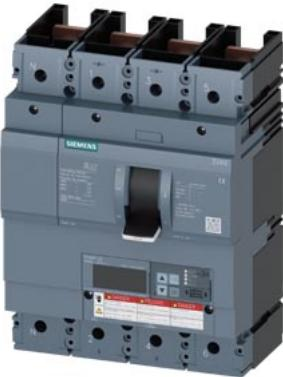
Interruttore automatico 3VA6 UL Frame 600 Classe del potere di interruzione L 150kA @ 480 V a 4 poli, protezione impianto ETU850, LSI, In=400A protezione da sovraccarico Ir=160A...400A protezione da cortocircuito Isd=0,6..10x In, li=1,5..12x In protezione del conduttore di neutro impostabile (OFF, fino al 160%) senza collegamento
