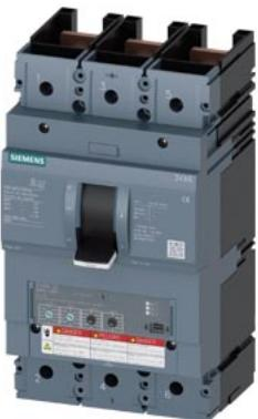
Interruttore automatico 3VA6 UL Frame 600 Classe del potere di interruzione L 150kA @ 480 V a 3 poli, protezione impianto ETU350, LSI, In=400A protezione da sovraccarico Ir=160A...400A protezione da cortocircuito Isd=1,5...10 x Ir, li=12 x In senza collegamento
