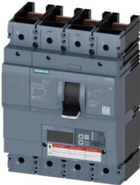
Interruttore automatico 3VA6 UL Frame 600 Classe del potere di interruzione C 100kA @ 480 V a 4 poli, protezione impianto ETU860, LSIG, In=400A protezione da sovraccarico Ir=160A...400A protezione da cortocircuito Isd=0,6..10x In, Ii=1,5..12x In protezione del conduttore di neutro impostabile (OFF, fino al 160%) protezione da guasto verso terra Ig=0,2...1 x In= tg=0,05-0,8s senza collegamento
