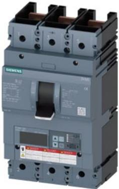
interruttore automatico 3VA6 UL frame 600 classe del potere di interruzione C 100 kA con 480V a 3 poli, protezione impianto ETU860, LSIG,  $In=400$  A protezione da sovraccarico, 100 % nominale  $Ir=160$  A ... 400 A protezione da cortocircuito  $Isd=0,6 \dots 10x In$ ,  $li=1,5..12x In$  protezione del conduttore di neutro opzionale con trasformatore di corrente esterno, fino a 160 % protezione da guasto verso terra  $lg=0,2 \dots 1 x In$ ,  $tg=0,05..0,8s$  senza collegamento
