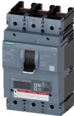
Interruttore automatico 3VA6 UL Frame 600 Classe del potere di interruzione C 100kA @ 480 V a 3 poli, protezione impianto ETU830, LIG, In=400A protezione da sovraccarico Ir=160A...400A protezione da cortocircuito li=1,5...12 x In protezione da guasto verso terra Ig=0,2...1 x In, tg=0,05-0,8s senza collegamento
