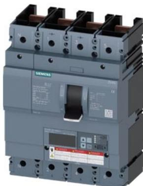
interruttore automatico 3VA6 UL frame 600 classe del potere di interruzione C 100 kA con 480V a 4 poli, protezione impianto ETU556, LSI,  $I_n=400$  A protezione da sovraccarico, 100 % nominale  $I_r=160$  A ... 400 A protezione da cortocircuito  $I_{sd}=0,6 \dots 10 \times I_n$ ,  $I_i=1,5 \dots 12 \times I_n$  protezione del conduttore di neutro regolabile (OFF, fino al 160 %) allarme di guasto verso terra segnalazione tramite EFB300 o COM senza collegamento
