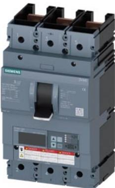
Interruttore automatico 3VA6 UL Frame 600 Classe del potere di interruzione C 100kA @ 480 V a 3 poli, protezione impianto ETU560, LSIG, In=400A protezione da sovraccarico Ir=160A...400A protezione da cortocircuito Isd=0,6..10x In, Ii=1,5..12x In protezione del conduttore di neutro opzionale con trasformatore di corrente, fino a 160% protezione da guasto verso terra Ig=0,2...1 x In, tg=0,05-0,8s senza collegamento
