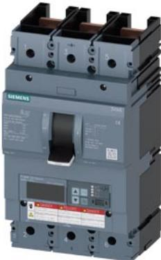
interruttore automatico 3VA6 UL frame 600 classe del potere di interruzione H 65 kA con 480V a 3 poli, protezione impianto ETU856, LSI, In=400 A protezione da sovraccarico, 100 % nominale Ir=160 A ... 400 A protezione da cortocircuito Isd=0,6 ... 10x In, li=1,5..12x In protezione del conduttore di neutro opzionale con trasformatore di corrente esterno, fino a 160 % allarme di guasto verso terra segnalazione tramite EFB300 o COM senza collegamento
