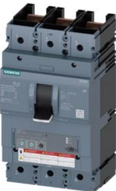
Interruttore automatico 3VA6 UL Frame 600 Classe del potere di interruzione H 65kA @ 480V a 3 poli, protezione impianto ETU320, LI, In=400A protezione da sovraccarico Ir=160A...400A protezione da cortocircuito I<sub>c</sub>=1,5...12 x I<sub>n</sub> senza collegamento
