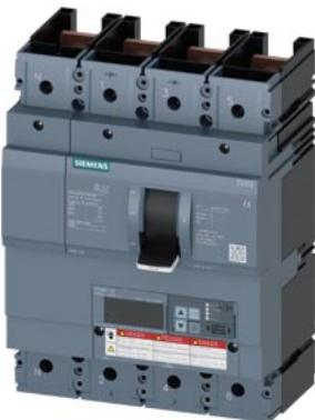
Interruttore automatico 3VA6 UL Frame 600 Classe del potere di interruzione M 35kA @ 480V a 4 poli, protezione impianto ETU850, LSI, In=400A protezione da sovraccarico Ir=160A...400A protezione da cortocircuito Isd=0,6..10x In, li=1,5..12x In protezione del conduttore di neutro impostabile (OFF, fino al 160%) senza collegamento
