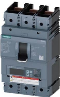
interruttore automatico 3VA6 UL frame 600 classe del potere di interruzione M 35 kA con 480V a 3 poli, protezione impianto ETU556, LSI, In=400 A protezione da sovraccarico, 100 % nominale Ir=160 A ... 400 A protezione da cortocircuito Isd=0,6 ... 10x In, li=1,5..12x In protezione del conduttore di neutro opzionale con trasformatore di corrente esterno, fino a 160 % allarme di guasto verso terra segnalazione tramite EFB300 o COM senza collegamento
