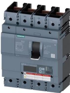
interruttore automatico 3VA6 UL frame 600 classe del potere di interruzione M 35 kA con 480V a 4 poli, protezione impianto ETU550, LSI, In=400 A protezione da sovraccarico, 100 % nominale Ir=160 A ... 400 A protezione da cortocircuito Isd=0,6 ... 10x In, li=1,5..12x In protezione del conduttore di neutro regolabile (OFF, fino a 150 %) senza collegamento
