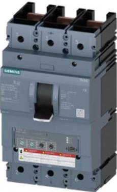
Interruttore automatico 3VA6 UL Frame 600 Classe del potere di interruzione M 35kA @ 480V a 3 poli, protezione impianto ETU330, LIG, In=400A protezione da sovraccarico Ir=160A...400A protezione da cortocircuito Ii=1,5...12 x In protezione da guasto verso terra Ig=0,2...1 x In, tg=0,1/0,3s senza collegamento
