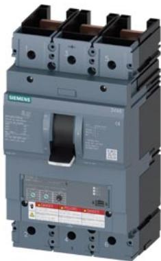
interruttore automatico 3VA6 UL frame 600 classe del potere di interruzione M 35 kA con 480V a 3 poli, protezione impianto ETU320, LI, In=400 A protezione da sovraccarico, 100 % nominale Ir=160 A ... 400 A protezione da cortocircuito Ii=1,5 ... 12 x In senza collegamento
