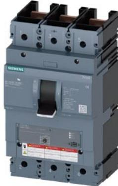
Interruttore automatico 3VA6 UL Frame 400 a 3 poli, protezione avviatore ETU310M, I, In=400A senza protezione da sovraccarico protezione da cortocircuito li=3 ... 13 x In senza collegamento
