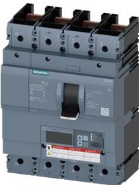
Interruttore automatico 3VA6 UL Frame 400 Classe del potere di interruzione L 150kA @ 480 V a 4 poli, protezione impianto ETU820, LI, In=400A protezione da sovraccarico Ir=160A...400A protezione da cortocircuito Ii=1,5...10 x In senza collegamento
