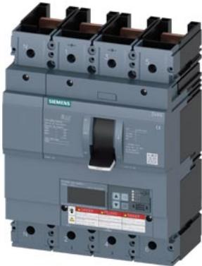
Interruttore automatico 3VA6 UL Frame 400 Classe del potere di interruzione C 100kA @ 480 V a 4 poli, protezione impianto ETU856, LSI, In=400A protezione da sovraccarico Ir=160A...400A protezione da cortocircuito Isd=0,6..10x In, li=1,5..10x In protezione del conduttore di neutro impostabile (OFF, fino a 100%) allarme di guasto verso terra Segnalazione tramite EFB300 o COM senza collegamento
