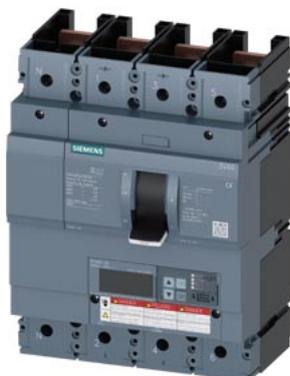
Interruttore automatico 3VA6 UL Frame 400 Classe del potere di interruzione C 100kA @ 480 V a 4 poli, protezione impianto ETU850, LSI, In=400A protezione da sovraccarico Ir=160A...400A protezione da cortocircuito I<sub>sd</sub>=0,6..10x I<sub>n</sub>, I<sub>i</sub>=1,5..10x I<sub>n</sub> protezione del conduttore di neutro impostabile (OFF, fino a 100%) senza collegamento
