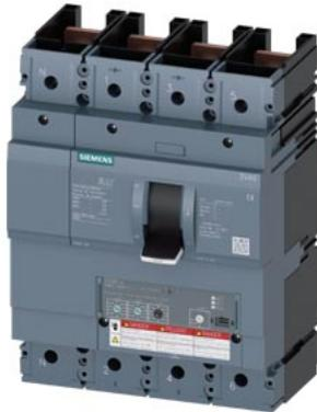
Interruttore automatico 3VA6 UL Frame 400 Classe del potere di interruzione C 100kA @ 480 V a 4 poli, protezione impianto ETU320, LI, In=400A protezione da sovraccarico Ir=160A...400A protezione da cortocircuito li=1,5...10 x In protezione del conduttore di neutro impostabile (OFF, 50%, 100%) senza collegamento
