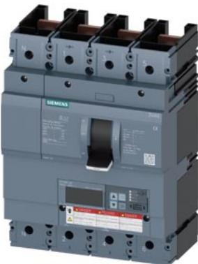
Interruttore automatico 3VA6 UL Frame 400 Classe del potere di interruzione H 65kA @ 480V a 4 poli, protezione impianto ETU550, LSI, In=400A protezione da sovraccarico Ir=160A...400A protezione da cortocircuito Isd=0,6..10x In, li=1,5..10x In protezione del conduttore di neutro impostabile (OFF, fino a 100%) senza collegamento
