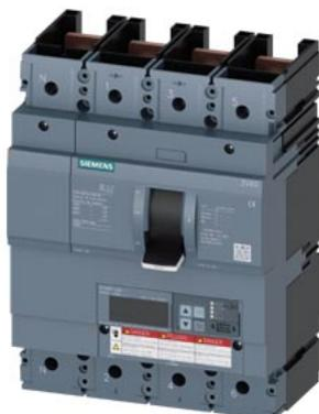
Interruttore automatico 3VA6 UL Frame 400 Classe del potere di interruzione L 150kA @ 480 V a 4 poli, protezione impianto ETU860, LSIG, In=250A protezione da sovraccarico Ir=100A...250A protezione da cortocircuito I<sub>sd</sub>=0,6..10x I<sub>n</sub>, I<sub>i</sub>=1,5..12x I<sub>n</sub> protezione del conduttore di neutro impostabile (OFF, fino al 160%) protezione da guasto verso terra I<sub>g</sub>=0,2...1 x I<sub>n</sub>= tg=0,05-0,8s senza collegamento
