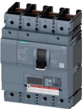
interruttore automatico 3VA6 UL frame 400 classe del potere di interruzione L 150 kA con 480 V a 4 poli, protezione impianto ETU560, LSIG, In=250 A protezione da sovraccarico, 100 % nominale Ir=100 A ... 250 A protezione da cortocircuito Isd=0,6 ... 10x In, li=1,5..12x In protezione del conduttore di neutro regolabile (OFF, fino al 160 %) protezione da guasto verso terra Ig=0,2 ... 1 x In tg=0,05 ... 0,8 s senza collegamento
