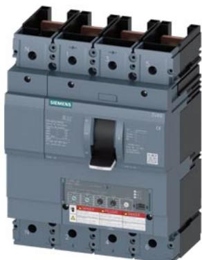
interruttore automatico 3VA6 UL frame 400 classe del potere di interruzione L 150 kA con 480 V a 4 poli, protezione impianto ETU350, LSI, In=250 A protezione da sovraccarico, 100 % nominale Ir=100 A ... 250 A protezione da cortocircuito I<sub>sd</sub>=1,5 ... 10 x I<sub>r</sub>, I<sub>i</sub>=12 x I<sub>n</sub> protezione del conduttore di neutro regolabile (OFF, 50 %, 100 %) senza collegamento
