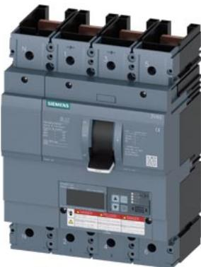
Interruttore automatico 3VA6 UL Frame 400 Classe del potere di interruzione C 100kA @ 480 V a 4 poli, protezione impianto ETU830, LIG, In=250A protezione da sovraccarico Ir=100A...250A protezione da cortocircuito Ii=1,5...12 x In protezione da guasto verso terra Ig=0,2...1 x In, tg=0,05-0,8s senza collegamento
