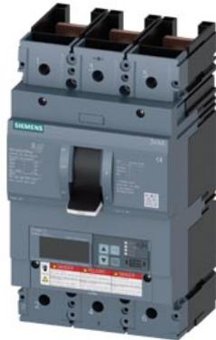
interruttore automatico 3VA6 UL frame 400 classe del potere di interruzione C 100 kA con 480V a 3 poli, protezione impianto ETU820, LI, In=250 A protezione da sovraccarico, 100 % nominale Ir=100 A ... 250 A protezione da cortocircuito li=1,5 ... 12 x In senza collegamento
