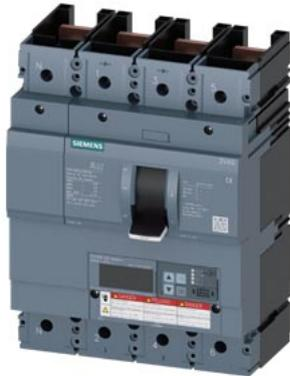
interruttore automatico 3VA6 UL frame 400 classe del potere di interruzione C 100 kA con 480V a 4 poli, protezione impianto ETU556, LSI,  $I_n=250$  A protezione da sovraccarico, 100 % nominale  $I_r=100$  A ... 250 A protezione da cortocircuito  $I_{sd}=0,6 \dots 10 \times I_n$ ,  $I_i=1,5 \dots 12 \times I_n$  protezione del conduttore di neutro regolabile (OFF, fino al 160 %) allarme di guasto verso terra segnalazione tramite EFB300 o COM senza collegamento
