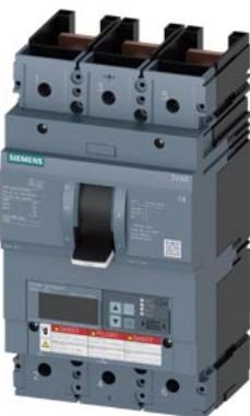
Interruttore automatico 3VA6 UL Frame 400 Classe del potere di interruzione C 100kA @ 480 V a 3 poli, protezione impianto ETU556, LSI, In=250A protezione da sovraccarico Ir=100A...250A protezione da cortocircuito Isd=0,6..10x In, li=1,5..12x In protezione del conduttore di neutro opzionale con trasformatore di corrente, fino a 160% allarme di guasto verso terra Segnalazione tramite EFB300 o COM senza collegamento
