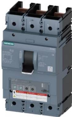
interruttore automatico 3VA6 UL frame 400 classe del potere di interruzione C 100 kA con 480V a 3 poli, protezione impianto ETU330, LIG, In=250 A protezione da sovraccarico, 100 % nominale Ir=100 A ... 250 A protezione da cortocircuito Ii=1,5 ... 12 x In protezione da guasto verso terra Ig=0,2 ... 1 x In, tg=0,1/0,3s senza collegamento
