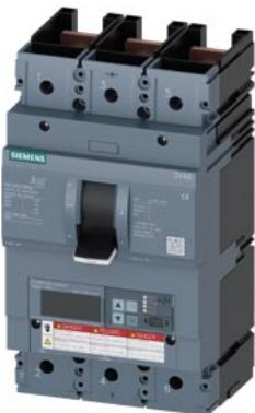
Interruttore automatico 3VA6 UL Frame 400 Classe del potere di interruzione H 65kA @ 480V a 3 poli, protezione impianto ETU856, LSI,  $In=250A$  protezione da sovraccarico  $Ir=100A...250A$  protezione da cortocircuito  $Isd=0,6..10x In$ ,  $li=1,5..12x In$  protezione del conduttore di neutro opzionale con trasformatore di corrente, fino a 160% allarme di guasto verso terra Segnalazione tramite EFB300 o COM senza collegamento
