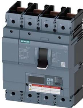
interruttore automatico 3VA6 UL frame 400 classe del potere di interruzione H 65 kA con 480V a 4 poli, protezione impianto ETU830, LIG, In=250 A protezione da sovraccarico, 100 % nominale Ir=100 A ... 250 A protezione da cortocircuito li=1,5 ... 12 x In protezione da guasto verso terra Ig=0,2 ... 1 x In, tg=0,05...0,8s senza collegamento
