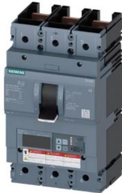
Interruttore automatico 3VA6 UL Frame 400 Classe del potere di interruzione H 65kA @ 480V a 3 poli, protezione impianto ETU820, LI, In=250A protezione da sovraccarico Ir=100A...250A protezione da cortocircuito Ii=1,5...12 x In senza collegamento
