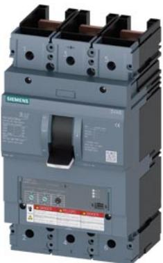
interruttore automatico 3VA6 UL frame 400 classe del potere di interruzione H 65 kA con 480V a 3 poli, protezione impianto ETU320, LI, In=250 A protezione da sovraccarico, 100 % nominale Ir=100 A ... 250 A protezione da cortocircuito Ii=1,5 ... 12 x In senza collegamento
