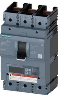
Interruttore automatico 3VA6 UL Frame 400 Classe del potere di interruzione M 35kA @ 480V a 3 poli, protezione impianto ETU850, LSI, In=250A protezione da sovraccarico Ir=100A...250A protezione da cortocircuito Isd=0,6..10x In, li=1,5..12x In protezione del conduttore di neutro opzionale con trasformatore di corrente, fino a 160% senza collegamento
