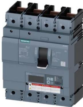
Interruttore automatico 3VA6 UL Frame 400 Classe del potere di interruzione M 35kA @ 480V a 4 poli, protezione impianto ETU820, LI, In=250A protezione da sovraccarico Ir=100A...250A protezione da cortocircuito li=1,5...12 x In senza collegamento
