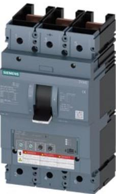
Interruttore automatico 3VA6 UL Frame 400 Classe del potere di interruzione M 35kA @ 480V a 3 poli, protezione impianto ETU350, LSI, In=250A protezione da sovraccarico Ir=100A...250A protezione da cortocircuito Isd=1,5...10 x Ir, Ii=12 x In senza collegamento
